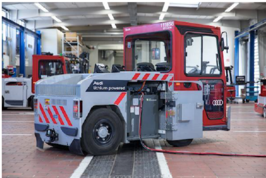
Figure 9 : Chariot de manutention utilisant des batteries de VE usagées (Audi e-tron)
