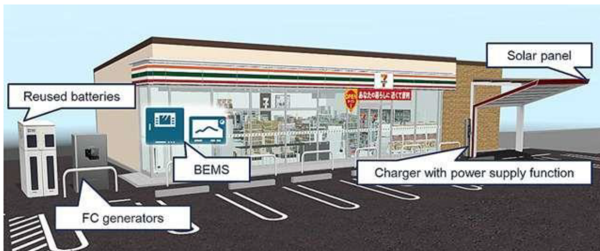
Figure 11 : Batteries de véhicules électriques réutilisées pour alimenter un commerce au Japon
